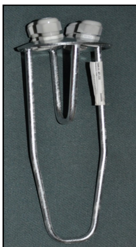
Mastetop dæksel : For mastetoppe Ø103 mm eller andre størrelser efter opgaver, monteret med PG - forskruninger for kabelgennemføring og kabelaflastning.
